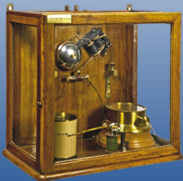
В ходе первых испытаний приемника была замечена его восприимчивость к атмосферным разрядам. Вскоре А.С. Попов сконструировал специальный прибор, названный разрядометчиком, позднее – грозоуметчиком, для круглосуточного приема электромагнитных колебаний естественного происхождения с автоматической записью их на бумажную ленту самописца. С июля 1895 года грозоуметчик применялся
