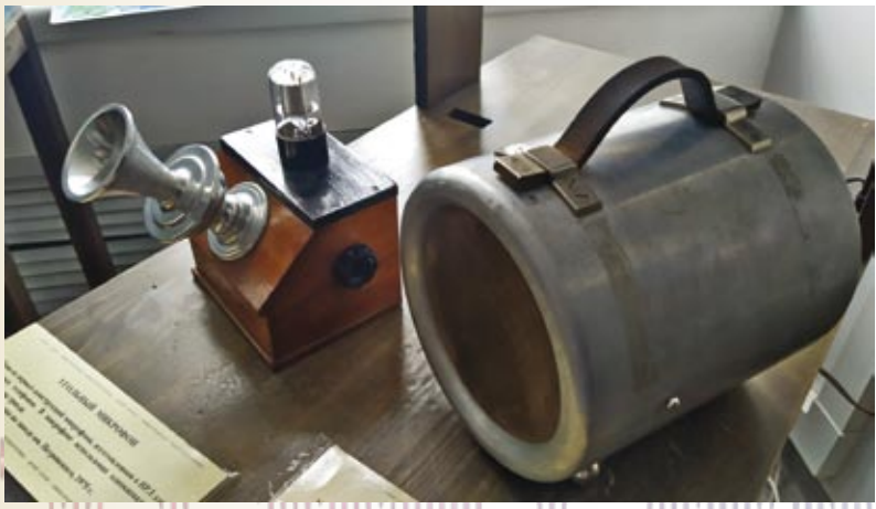
Электростатический микрофон для дикторских передач (справа) в экспозиции Музея «НРЛ»
