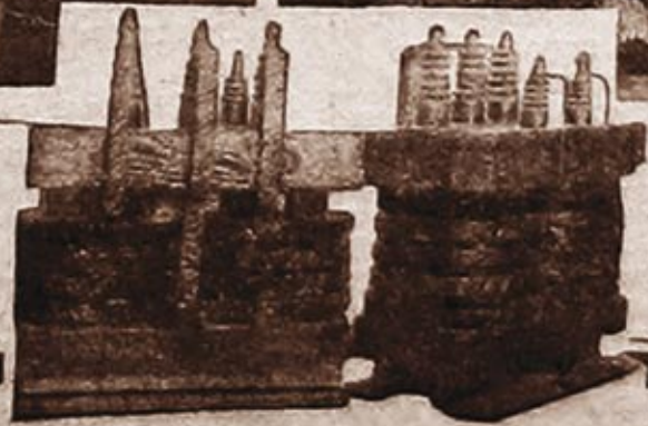
2. Трансформаторы для питания ламп.
