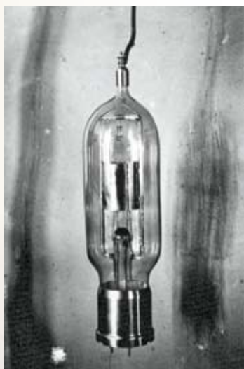
Трубка осциллографическая конструкции Г.А. Остроумова, сотрудника лаборатории Б.А. Остроумова. Экспонат Музея «Нижегородская радиолaborатория»
