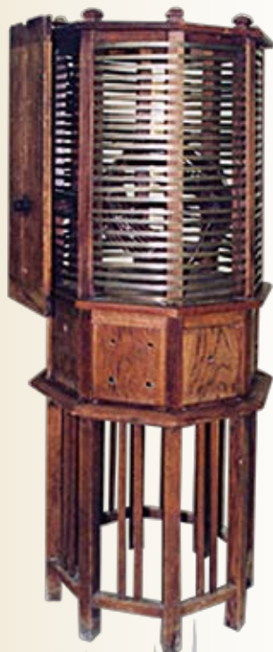
Антенный вариометр радиостанции «Малый Коминтерн». Экспонат музея «Нижегородская радиолaborатория»
