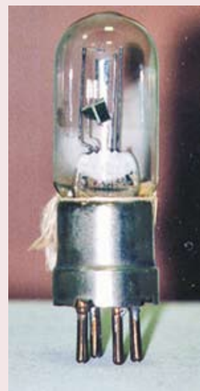
Радиолампа «Малютка» — приемно-усилительный триод с торированным катодом, тип ТВ. Разработка М.А. Бонч-Бруевича
