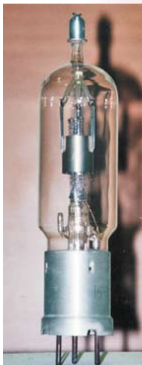
Радиолампа ГИ-150 генераторная, без охлаждения. Конструкция М.А. Бонч-Бруевича
