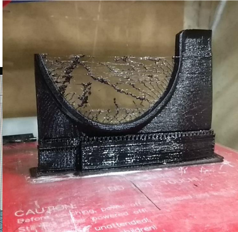
Напечатанные детали — правое и левое передние крылья
