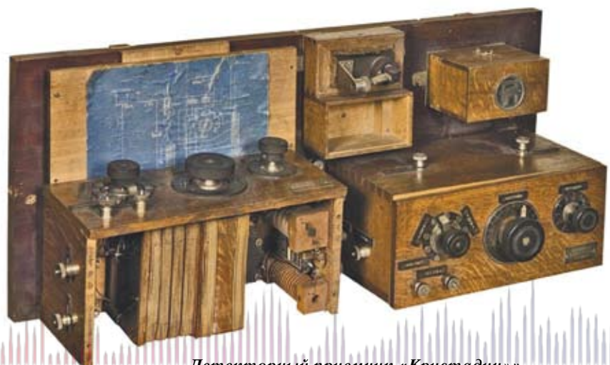
Детекторный приемник «Кристадин» О.В. Лосева. Экспонат ЦМС имени А.С. Попова
