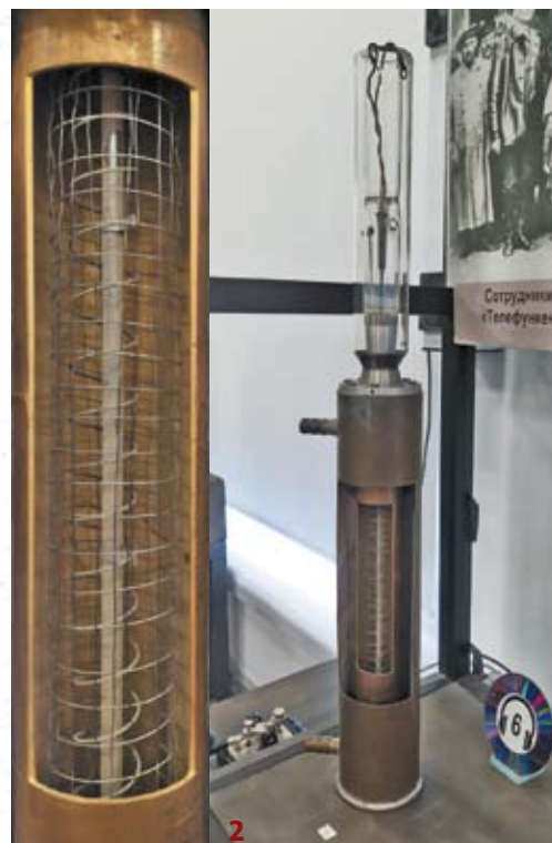
Лампа мощностью 25 кВт М.А. Бонч-Бруевича с внешним медным анодом 1923 года. 1 — Из «Пять лет работы НРЛ...» С. 14; 2 — из экспозиции Музея «Нижегородская радиолaborатория»
