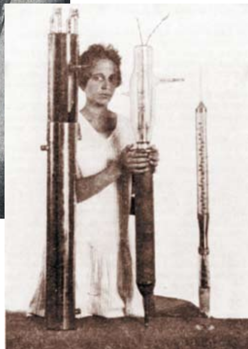
Лампа мощностью 25 кВт с наружным водяным охлаждением. Стоит сборщица О.Н. Соболева.
