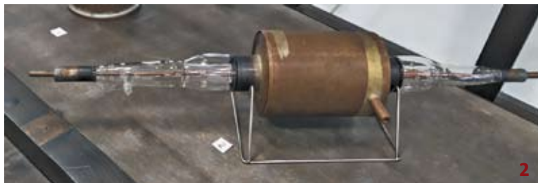
Генераторная лампа с внешним медным анодом 5 кВт. 1 — Х.А. Иоффе. Приборы НРЛ... С. 61; 2 — из экспозиции Музея «Нижегородская радиолaborатория»
