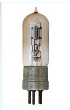
Приемно-усилительная лампа «УА-1». 1922–1924 годы. На цоколе гравировка: «Made in Russia. Радиолаб»
