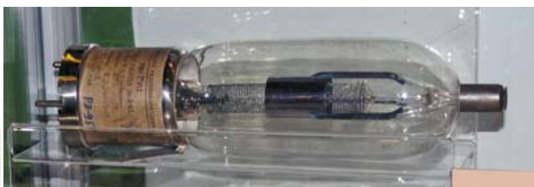
Генераторная лампа «ГИ-1». 1923–1924 годы. Из экспозиции ЦМС имени А.С. Попова. https://www.chipmaker.ru/gallery/
