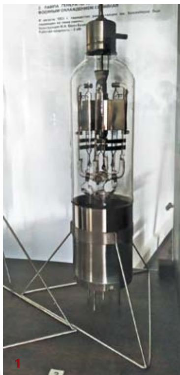
Генераторная лампа с внутренним водяным охлаждением типа МВ серийная. 1 – Из экспозиции Музея «Нижегородская радиолaborатория»; 2 – Х.А. Иоффе. Приборы НРЛ... С. 62
