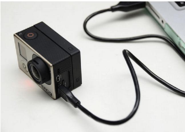
Рис.4. Подключение камеры к компьютеру
