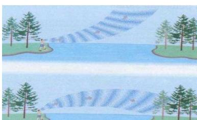
Рис.6. Преломление звука в воздухе.
