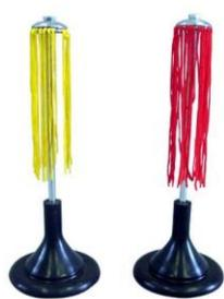
Это прибор, состоящий из узких полосок тонкой бумаги, прикрепленных к держателю на металлическом изолированном штативе (рис. 1).
