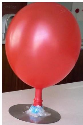
К старому компакт-дису приклеим небольшой пластиковый цилиндр, и наденем на него воздушный шарик. Через отверстие в диске надуем его и закрутим над диском. Теперь, если положить диск на гладкую поверхность и отпустить шар, то он раскрутится, воздух будет выходить через нижнее отверстие в диске и вся установка будет без трения скользить по поверхности.
