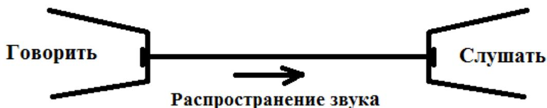
Рис. 1. Устройство вербочного телефона.
